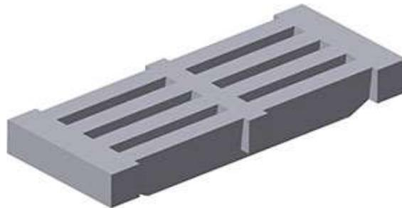
Колосник чугунный является частью печных решеток, который устанавливается в печах для обогрева. Также их можно использовать и для бань, работающих на дровах. Колосниковые решетки состоят из нескольких колосников чугунных и служат для обеспечения горения топлива в печах. Это происходит за счет подачи кислорода в нижний слой топливника. Если колосник чугунный отсутствует, горение в печах невозможно, так как без доступа кислорода процесс горения не произойдет.
